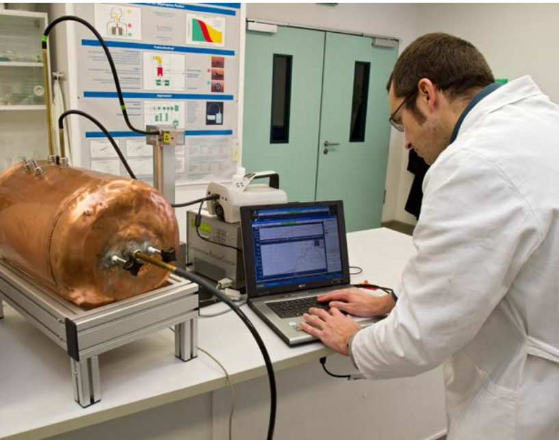
Ermittlung des Staubungsverhaltens von Nanomaterialien am Prüfstand der Bundesanstalt für Arbeitsschutz und Arbeitsmedizin.
