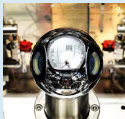
Titelbild: An der Physikalisch Technischen Bundesanstalt werden die weltweit perfektesten, nanometergenau geformten Silizium-Einkristallkugeln hergestellt.
