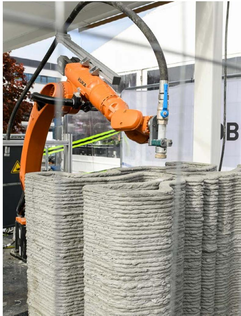
Präsentation eines 3D-Betondruckroboters auf einem Firmenevent.
