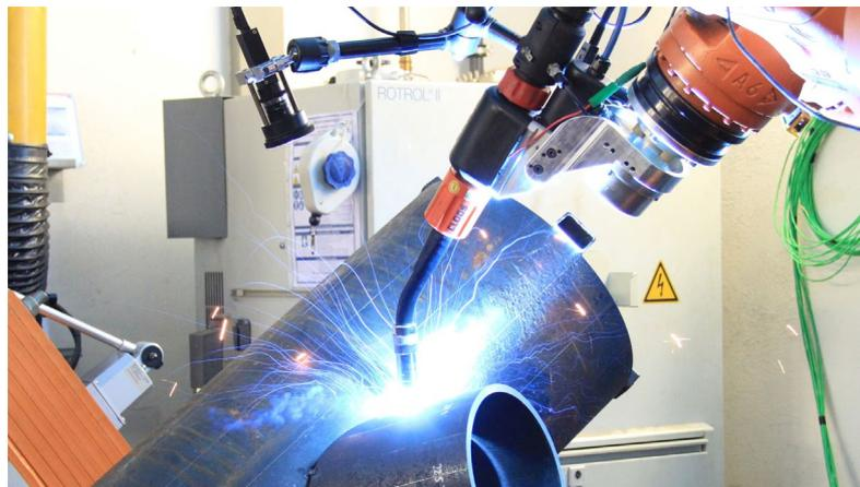
Leichtbaupotenziale erschließen durch Digitalisierung der Fertigungs- und prüfkette: Hier beim Schweißen der komplexen Nähte von Gitterfundamenten für Windenergieanlagen.
