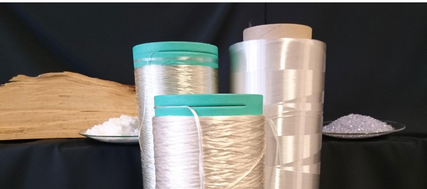
Ausgangsmaterialien für die Herstellung nachhaltiger Verbundwerkstoffe: Hybridgarn (vorne) bestehend aus einer cellulosischen Verstärkungsfasern (hinten links) und einer Matrixfaser auf Basis modifizierter Cellulose (hinten rechts).
