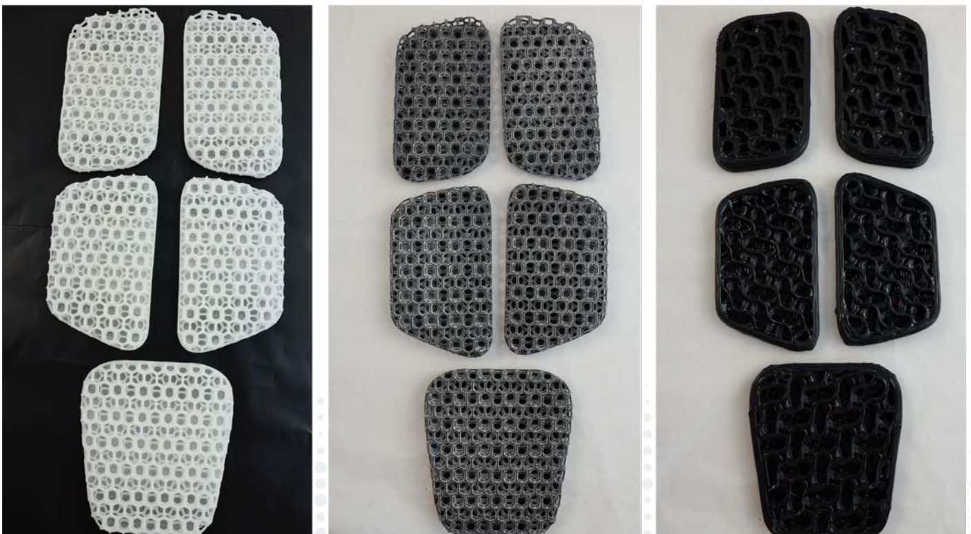
3D-gedruckte Rucksack-Pads aus dem Projekt MonoMat. Links und Mitte: Pulver 3D-Druck mit teilweise Altpulver. Rechts: Granulat 3D-Druck aus geschredderten Bauteilen.
