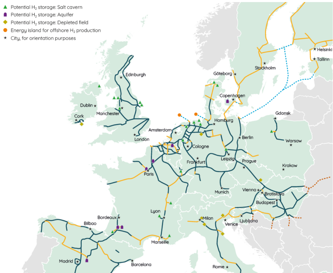
Abbildung 2.7 Entwurf für ein europäisches Wasserstoff-Backbone im Jahr 2035 (gelb: neugebaute Leitung, blau: umgewidmete Leitung), Quelle: (European Hydrogen Backbone initiative, 2021)
