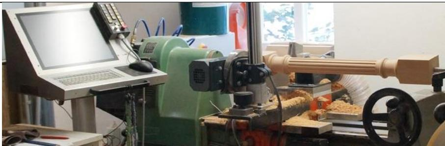
Herstellung von kannelierten Säulen auf der CNC-Maschine
