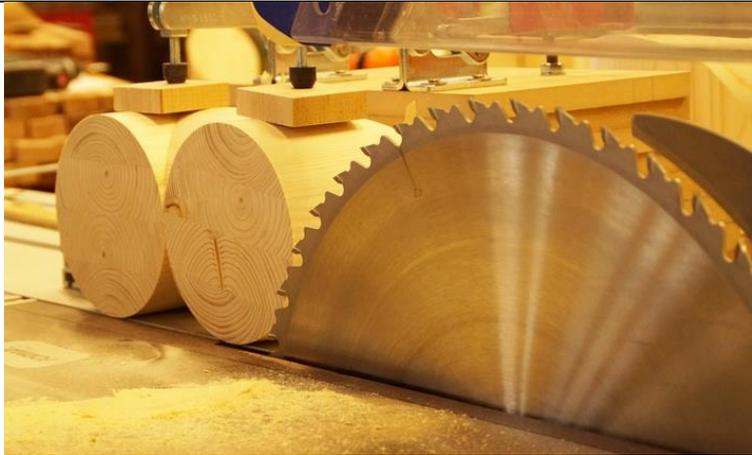
Das Ablängen von Drehteilen ist ohne korrekte Vorrichtung für Mensch und Maschine extrem gefährlich und verboten.
