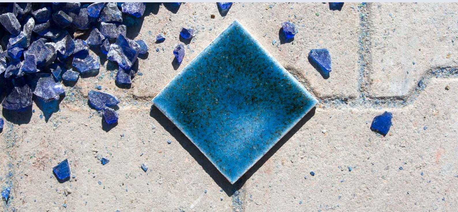
Fliesen aus recyceltem Bauschutt
