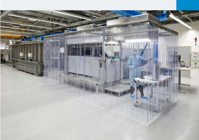
Inline-Epitaxieanlage ProConCVD im NexWafe Technologiezentrum
