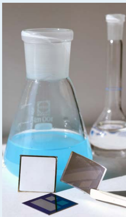
Auf dem Bild sind Bestandteile einer Solarzelle zu sehen, die im Rahmen von EASi entwickelt werden: metallische Precursorschicht (weiß), epitaxiefrei gewachsene InP-Absorberschicht (grau) und Si-Bottomzelle (blau strukturiert).
