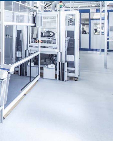
Auf der Demolinie der Firma Meyer Burger (Germany) werden neue Verfahren zum Herstellen von Hochleistungszellen mit über 22 Prozent Wirkungsgrad getestet.
