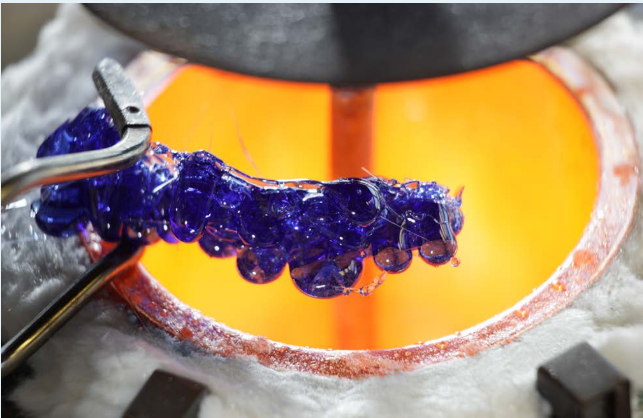
Glassmelze aus dem Induktionsofen zur Herstellung von Glaslot-Dichtungen für Brennstoffzellen
