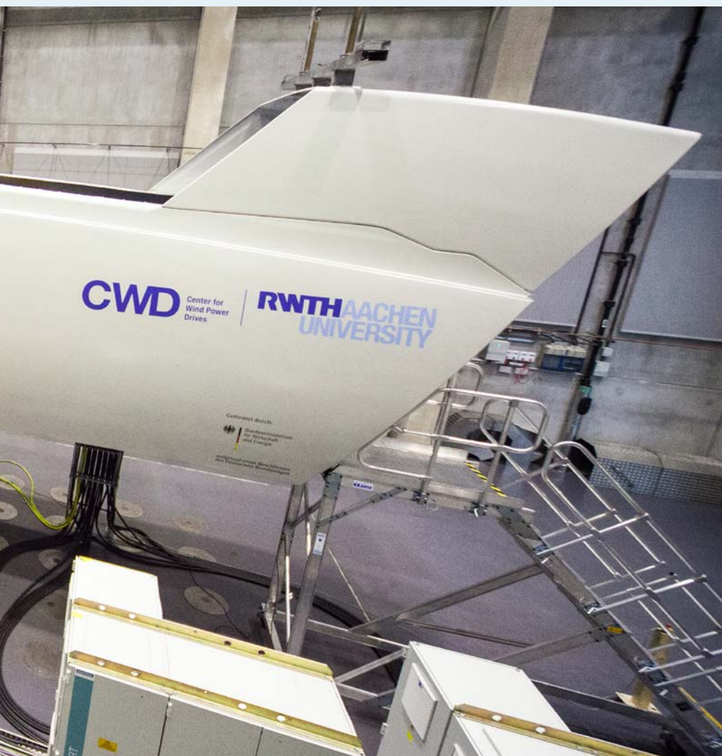
Auf dem 4-Megawatt-Systemprüfstand an der RWTH Aachen durchläuft die Forschungsgondel intensive Tests.
