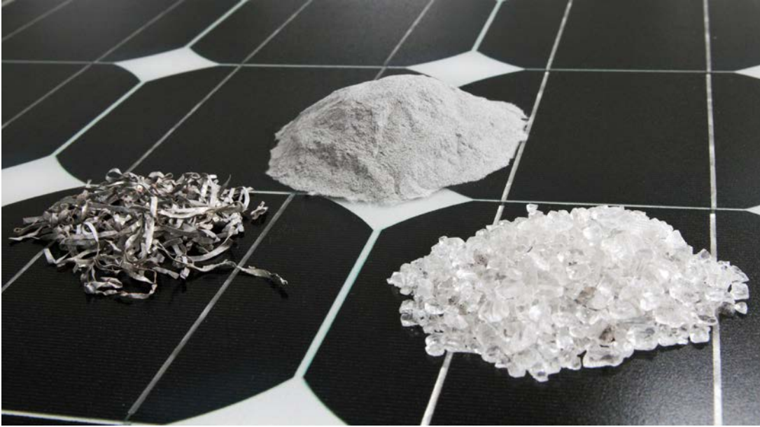
Im Forschungsvorhaben EoL-Cycle werden unter anderem Metalle, Silizium und Glas (von li. nach re.) aus ausgemusterten Photovoltaikmodulen zurückgewonnen.
