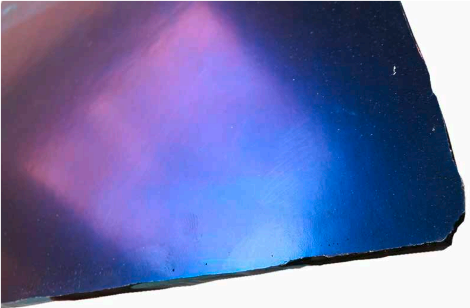
Platte aus UHPC mit spektral-selektiver Beschichtung
