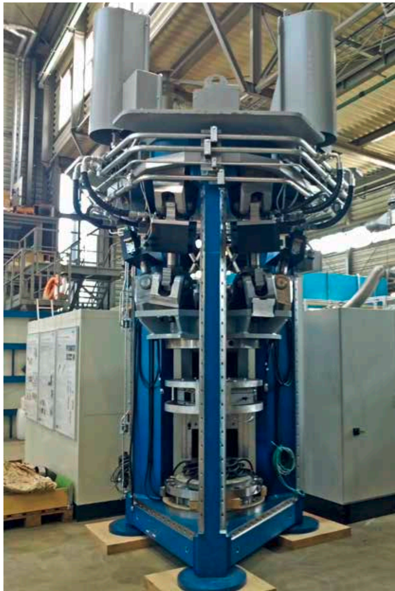
Schweißroboter für Casing-Rohre
