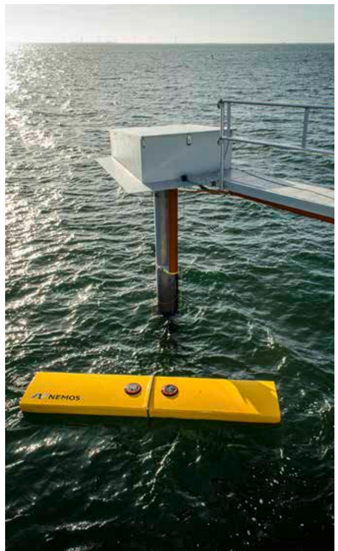
NEMOS Wellenkraftwerk im Maßstab 1:5 beim Test im natürlichen Seegang am dänischen Limfjord
