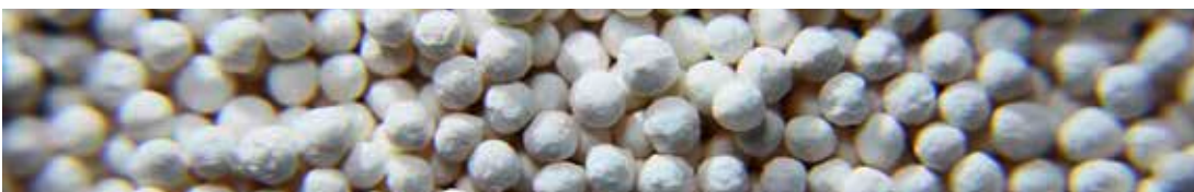
Salzprägnierte Zeolithe aus dem Forschungsvorhaben EnErChem
