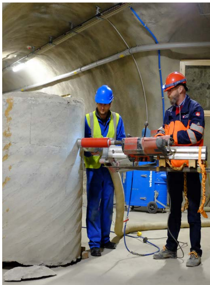
Entnahme einer Tonsteinprobe aus einem Großbohrkern
