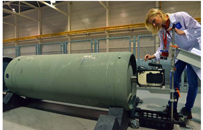
Messung von Uranhexafluorid durch eine Safeguardsinspektorin – URENCO
