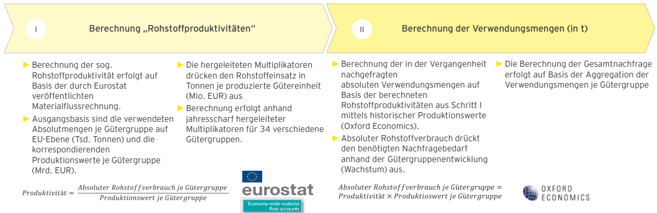
Abbildung 15: (Vereinfachtes) Vorgehen zur Modellierung von Verwendungsmengens ausgehend von einer Entwicklung der Produktionswerte der Gütergruppen - die Nachfrage stellt die Summe der verwendeten bzw. verbrauchten Rohstoffe dar.
