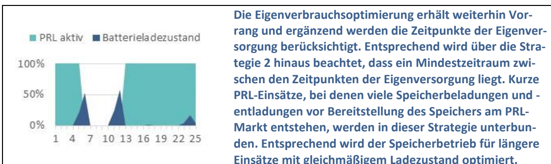
Bild 3.3 Strategie 3: Anteilige Nutzung der Speicherkapazität am PRL-Markt, sofern diese nicht zur Eigenversorgung benötigt wird und über einen Mindestzeitraum verfügbar ist
