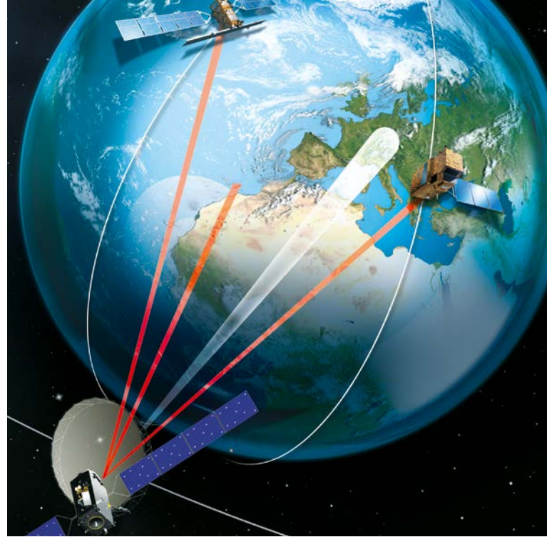
Alphasat und Sentinel 1A tauschen Daten per LCT aus.
