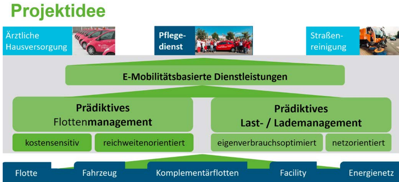
Abbildung 21: Einbindung der mobilitätsrelevanten Infrastrukturkomponenten in das Energienetz und das Energiemanagement des Gebäudes sowie in das Lademanagement durch Integration in ein übergreifendes IT-basiertes Einsatzmanagement der Dienstleistungserbringung
