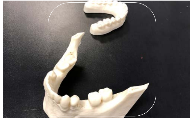
Vorne: 3D-Druck-Kiefermodell für die Planung und Herstellung von Zahnimplantaten; hinten: 3D-Zahnreihen-Modell für die Herstellung von Korrekturschienen.
